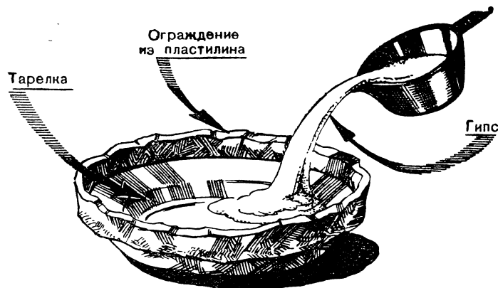
Формовка тарелки гипсом.
